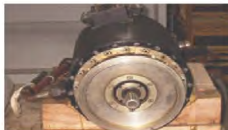
图 6 某装备用油冷 60kW 高压直流电励磁双凸极发电机
