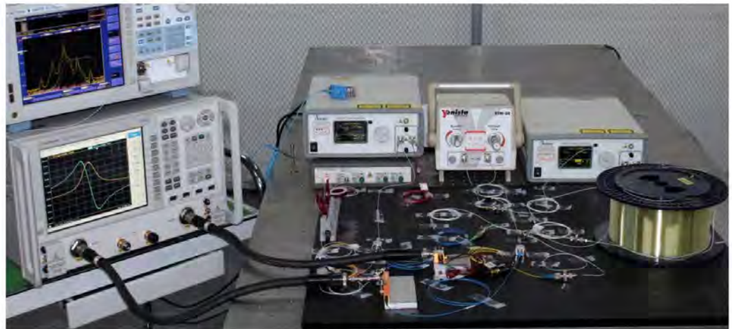
图 1 演示系统及测量光纤布里渊散射 10MHz 带宽的幅相响应
