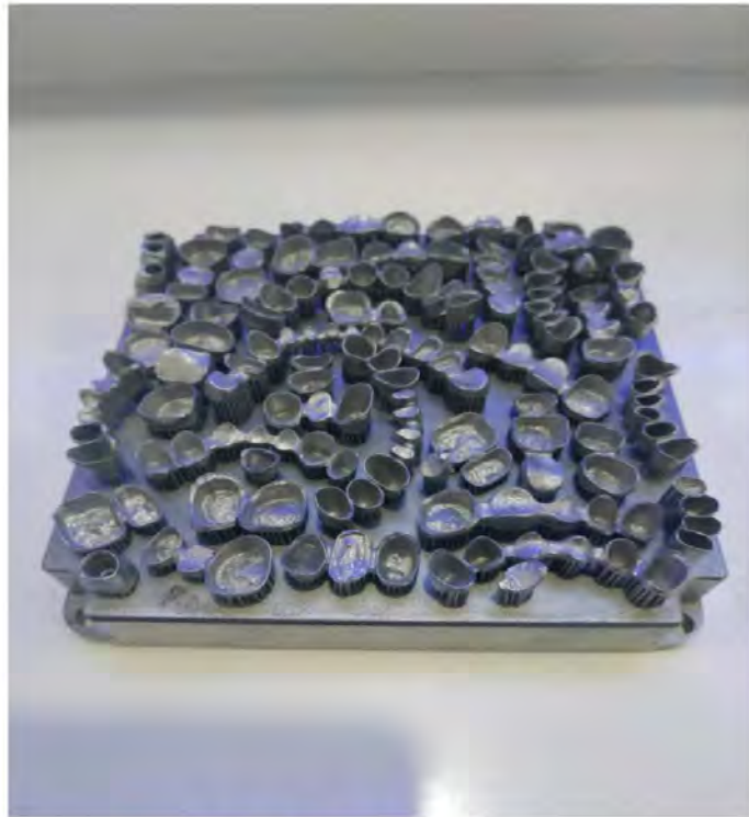
图 2 大尺寸成形方缸打印批量义齿
