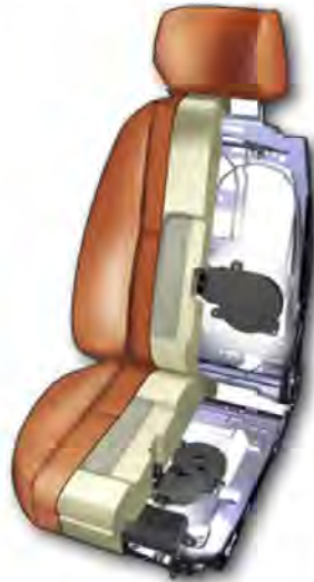
图 1 近体调温装置应用在车辆空调座椅时的安装位置与结构示意图
