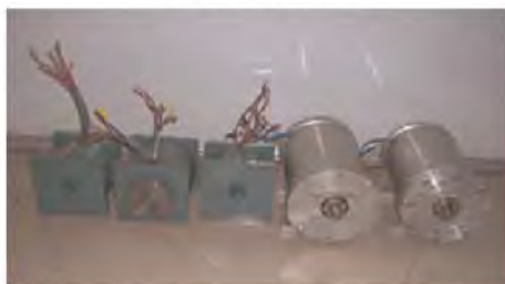
图 7 研发的双凸极电机系列 (200W-2kW)
