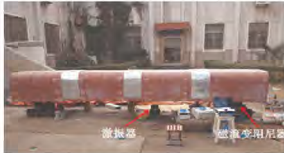
图 6 某列车模型半主动控制减振试验现场
