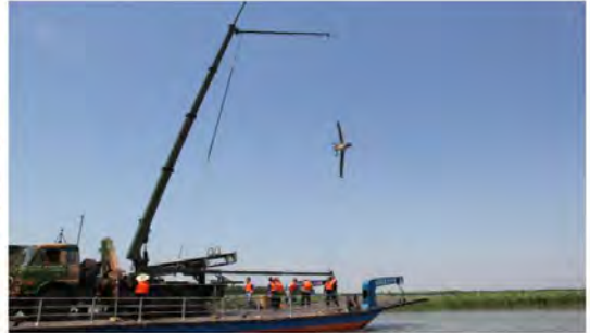
图 2 载垂绳精确定点回收
