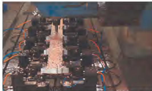
图 4 浮动装夹自适应加工工艺装备应用现场
