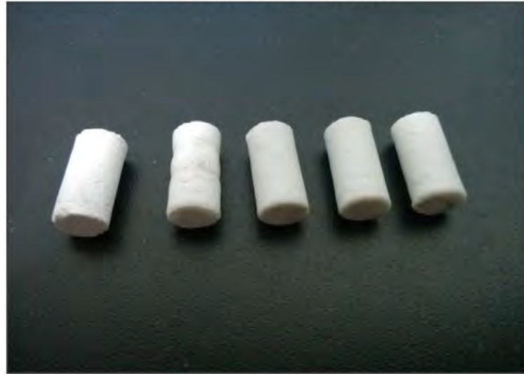
图 2 螯合型 HA 骨水泥样品固化后的宏观形貌
