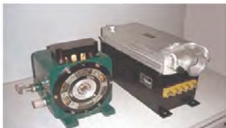
图 5 某装备液压泵用 9kW 双凸极无刷直流电动机及其控制器
